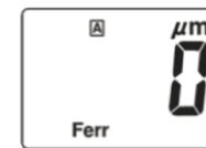
2. Положите пластиковую калибровочную пластину на непокрытую сторону металлической калибровочной шайбы. Прижмите сенсор прибора к калибровочной пленке, дождитесь, пока замер не будет произведен и показатели не появятся на дисплее (произвучит звуковой сигнал) затем снимите прибор с шайбы.
