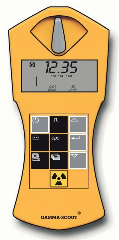
GAMMA-SCOUT® wird durch eine Lithium-Thionylchlorid-Zelle mit Strom versorgt, die eine Spannung von 2,7 bis 3,7 Volt aufweist. Die Funktion des Gerätes bleibt bis zu einer Zellenspannung von 2,8 Volt gewährleistet. Fällt die Zellenspannung unter diesen Wert, erscheint im Display das Batteriesymbol. Die Daten bleiben auch bei völligem Spannungsausfall erhalten. Das Modell RECHARGEABLE hat einen über die USB-Schnittstelle (oder das mitgelieferte Stecker-Netzteil) ladbaren Akku (S. 6).
