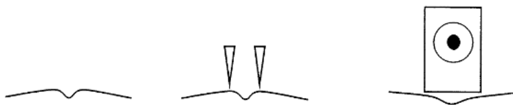
Ударное воздействие на верхнюю часть и исправление вмятины
